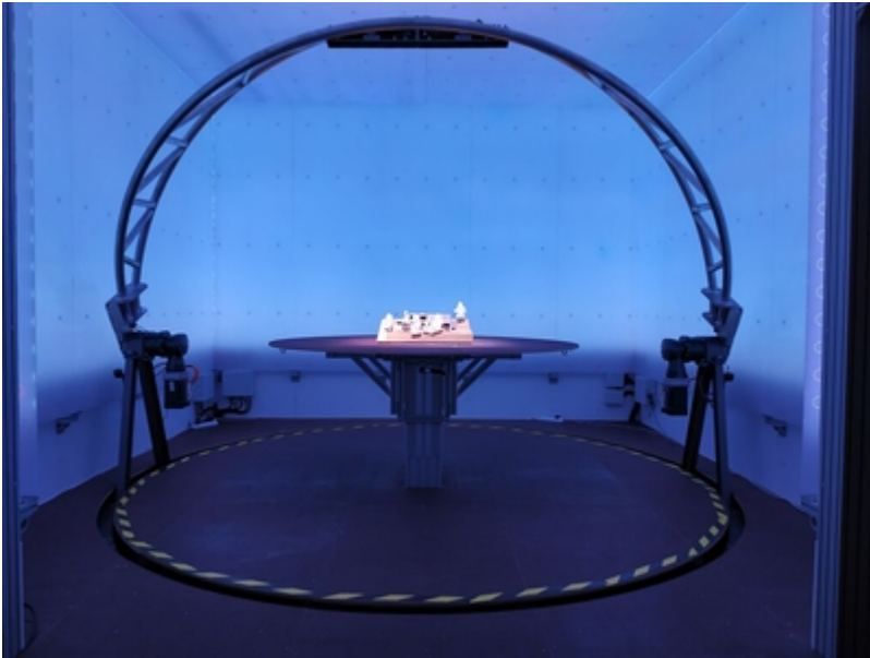
Le simulateur d'éclairage soleil mécanique-ciel artificiel du Laboratoire Lumière de l'ENSAS
