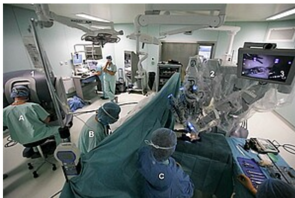
Intervention de microchirurgie robotique : 1 console chirurgicale / 2 robot télémanipulateur 3 écran de contrôle du champ opératoire A chirurgien / B anesthésiste /C instrumentiste
